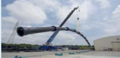
管と管との継手部分に隙間を設けて布設することで、地震時の地盤の動きに合わせて伸び縮みや曲がる機能を持たせています。
