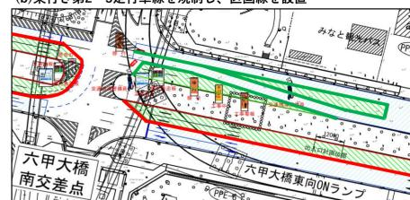
(c)東行き第1・2走行車線を規制し、仮防護(カラーコーン)を設置
