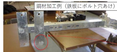
BOX裏に鋼材固定用アタッチメントを取り付け、鉄板と固定
