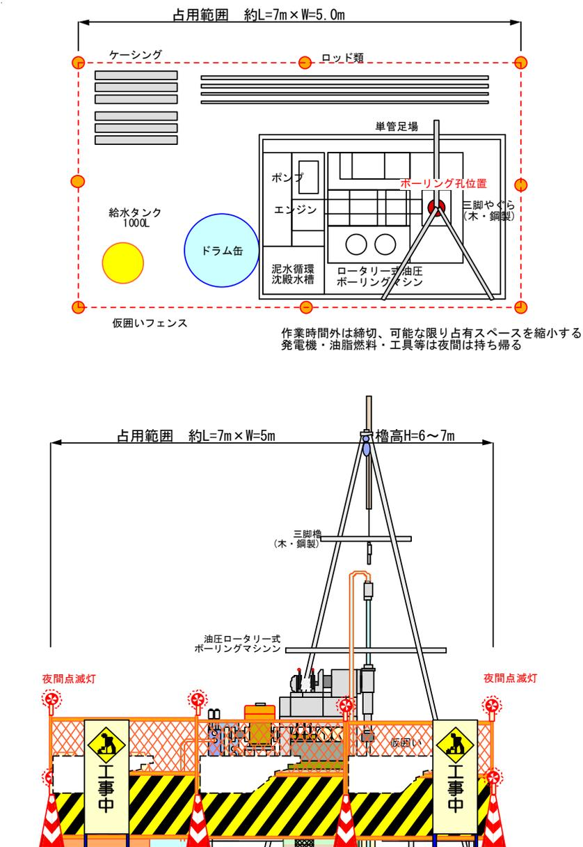
図一ボーリング仮設概要図
