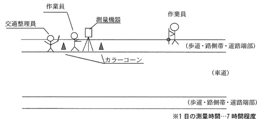
【作業概要図・断面図】
